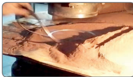
Pressen des Sinter-Rohlings
