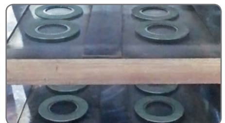
Pressvorgang der Lamellen unter Hitze
